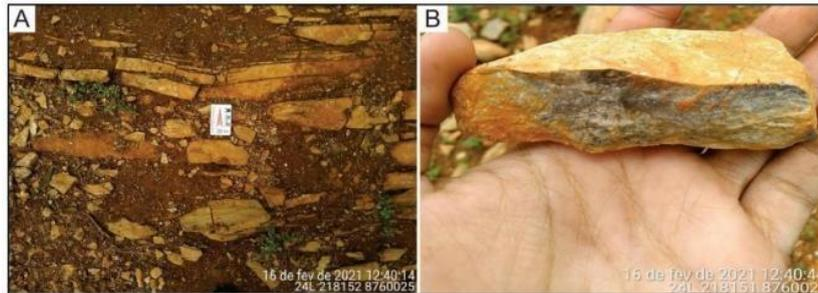
**Figura 25:** Calcarenito com laminação ondulada e intensamente fraturado (A) e amostra de mão do calcárenito (B) da Unidade Gabriel
