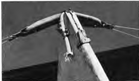
Abb. 146. Zögling mit Federung für die oberen Abfangdrähte.
