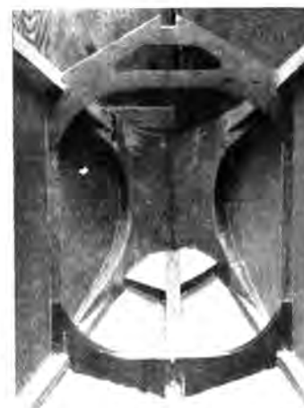
Abb. 71. Rumpfnase aus Sperrholz verleimt.
