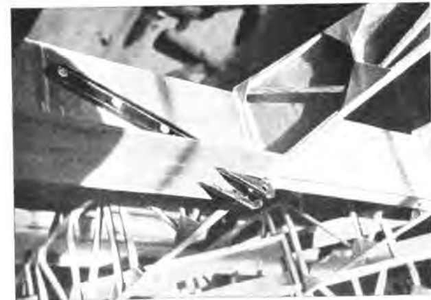
Abb. 105. Beschlagaustritt wird mit einer Sperrholzecke umgeben.
