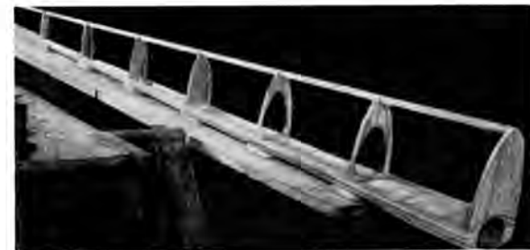
Abb. 139. Höhenruderholm mit aufgesetzter Rippennase und Sperrholzrohr.
