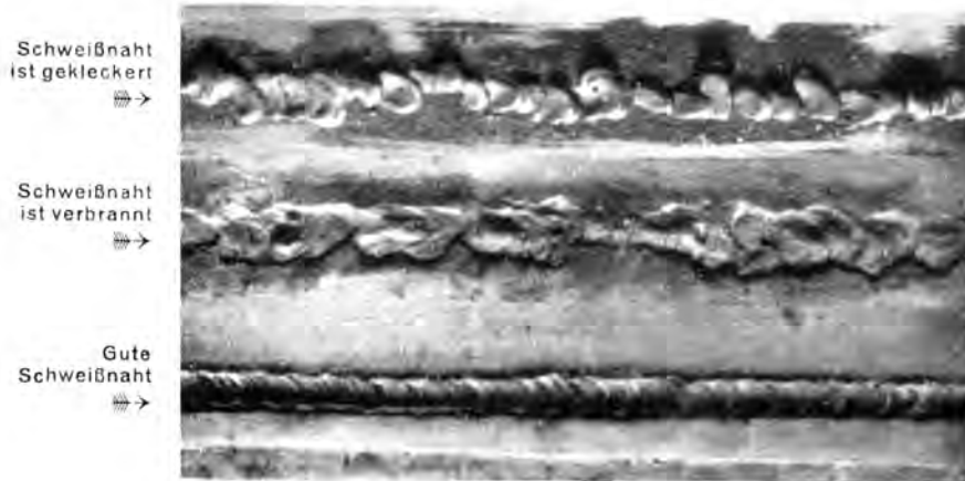
Abb. 21. Schweißnähte.
