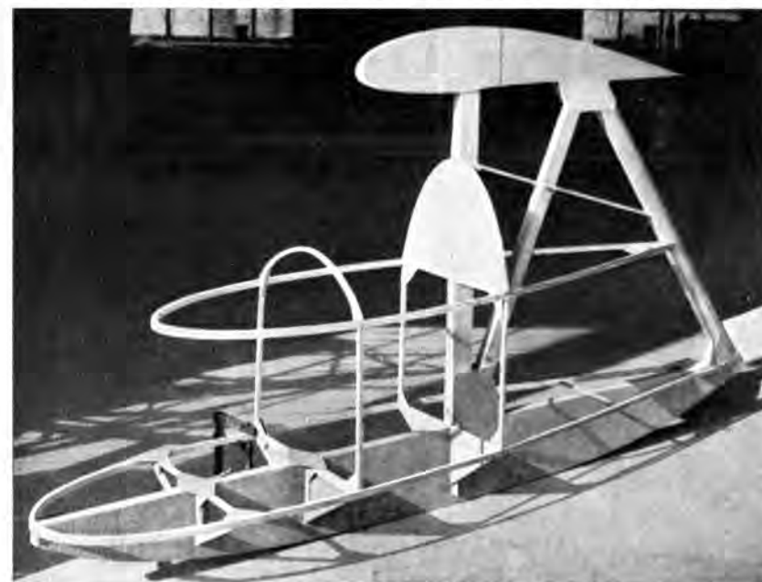
Abb. 111. Spante am Spannturm 3 .
