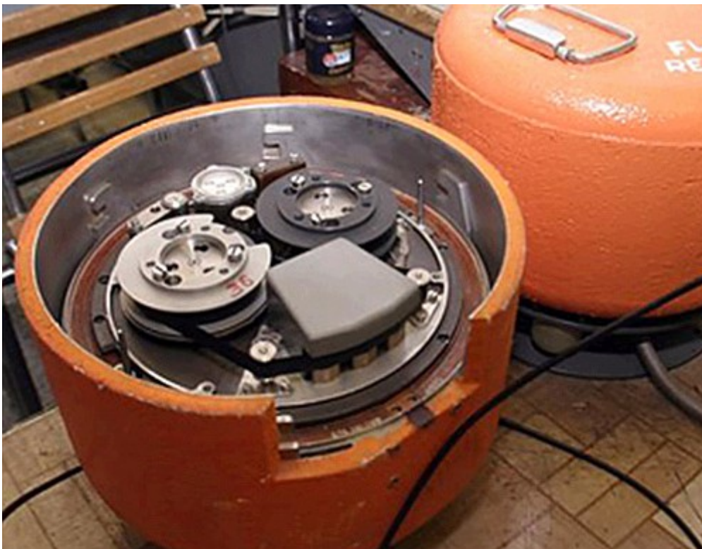
25 pav. Juostos traukimo mechanizmas konteineryje
