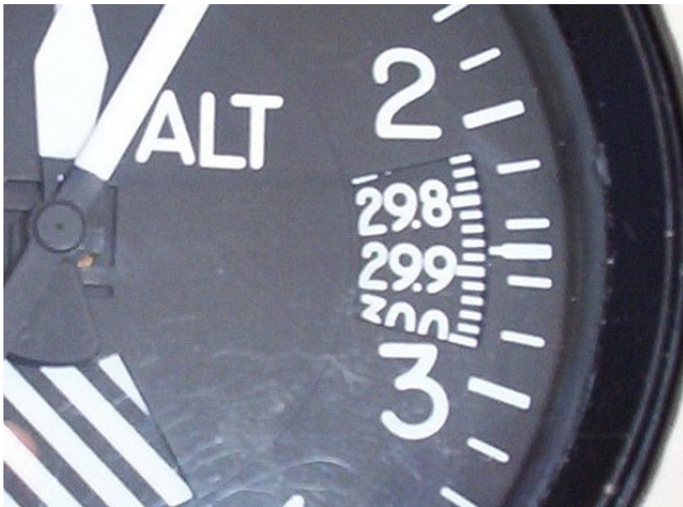
12 pav. Atraminio slėgio skalė, pažymėta gyvsidabrio stulpelio coliais
