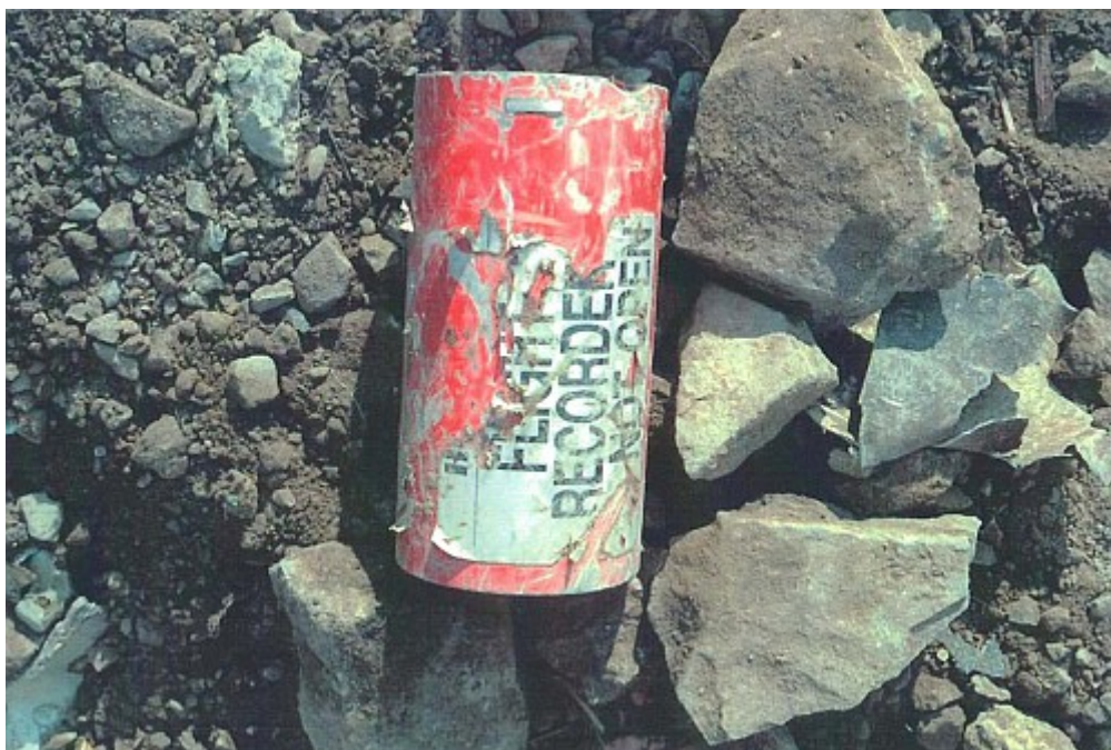
29 pav. Konteineris po avarijos
