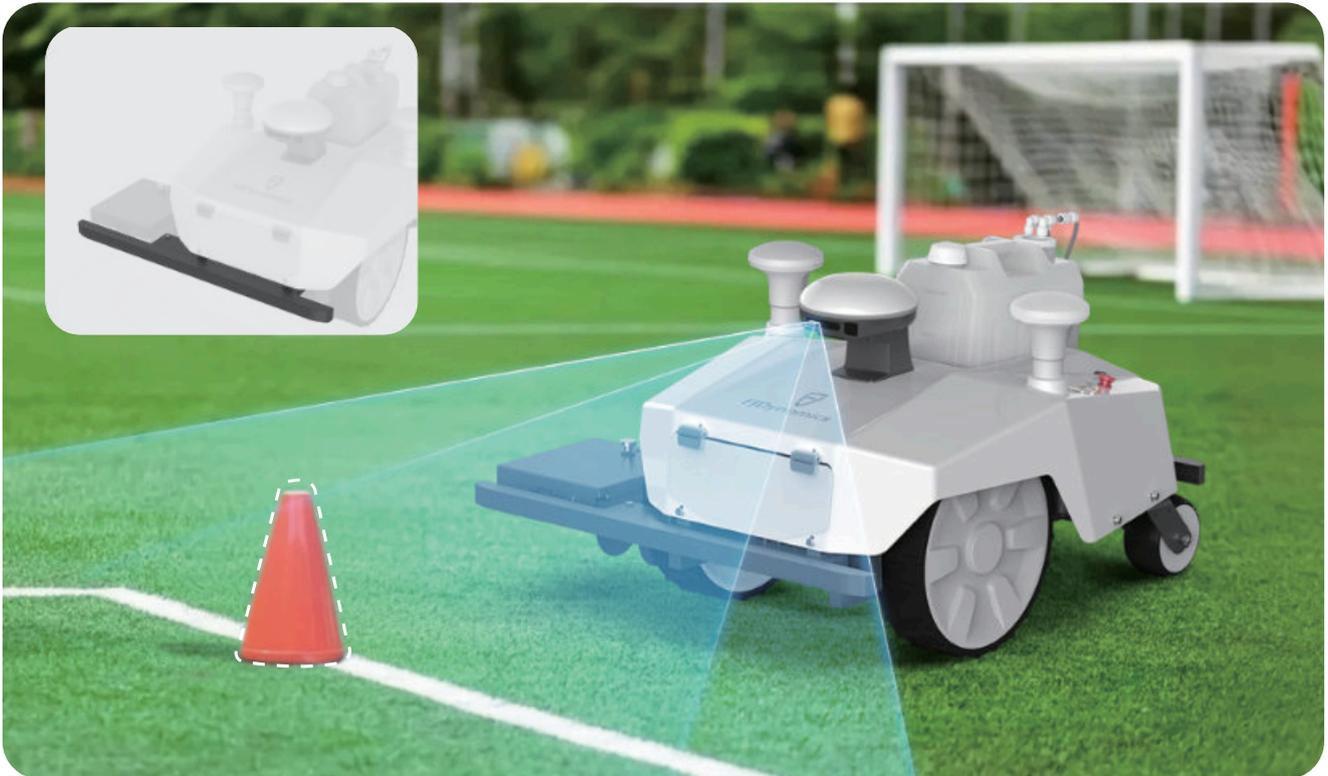
Équipé d'une caméra binoculaire permettant l'arrêt automatique lors de la détection d'objets durant le traçage, offrant des performances constantes même de nuit.
