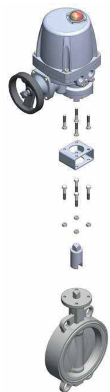
Rys.6. Montaż napędu elektrycznego na zaworze za pomocą wspornika
