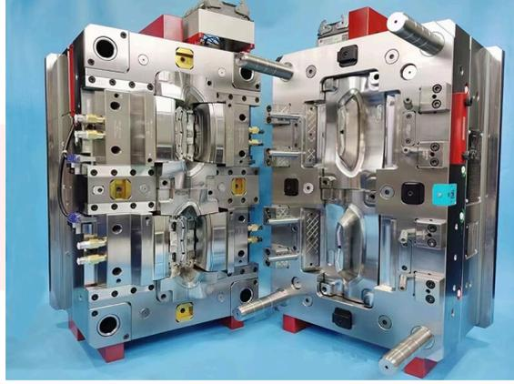
الأسطوانة في عملية الحقن هي التي تعطي الشكل المطلوب للمنتج البلاستيكي. تمامًا كما يتم صب السكر المعقود في أشكال مختلفة باستخدام قالب، أو كيف يعطي قالب الثلج شكل مكعبات الثلج، تسمح الأسطوانة في ماكينة الحقن للبلاستيك المنصهر بالتصلب في شكل معين.
