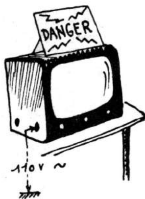
Fig. 1-2. — Lorsqu'on travaille sur un téléviseur alimenté directement par le réseau alternatif, on peut, afin d'éviter des secousses désagréables et parfois dangereuses, faire usage d'un transformateur d'isolement de rapport 1/1 (c'est-à-dire fournissant au secondaire une tension égale à la tension primaire).
