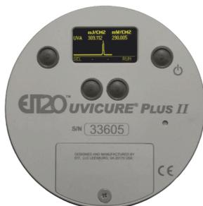
UviCure Plus II Profiler は、追加のプロファイリング機能を備えたシングルバンドUV放射計であり、研究室、R&D、生産現場、フィールド環境での詳細なUV解析向けに設計されています。
