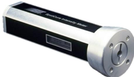
EIT 2.0 SpotCure®は、スポット硬化システムにおけるUV強度測定のための高速かつ高精度なソリューションです。コンパクトで操作が簡単なこの一体型ハンディデバイスには、UV出力の検証や監視において新たな基準を確立します。ランプ性能の評価、ライトガイドの状態確認、硬化セットアップの最適化など、あらゆる用途でSpotCureは信頼できる結果を提供します。高精度光学系、長寿命バッテリー、多様なアダプター対応を備え、耐久性の高いポータブル設計により、場所を問わず正確な測定を実現します。
