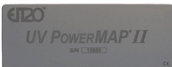
PowerMAP IIは、EIT 2.0 LLCが開発したプロファイリング用紫外線放射計で、4つのスペクトル領域（UVA、UVB、UVC、UVV）にわたる広帯域紫外線源の測定を目的としています。以下の測定が可能です：
