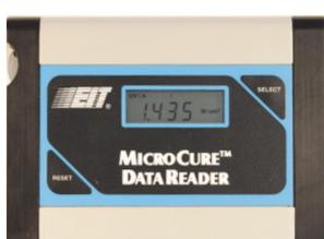
MicroCure® は、EIT 2.0 LLC によって開発されたコンパクトな単一波長帯域のUV放射計で、小型またはアクセスが難しいUV硬化環境向けに設計されています。エネルギー密度 (J/cm<sup>2</sup>) とピーク照度 (W/cm<sup>2</sup>) の両方を測定でき、高温や狭い空間での品質管理に最適です。
