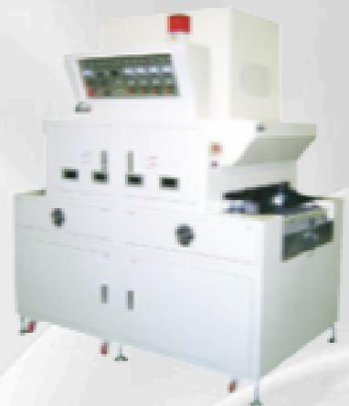
UV硬化は、紫外線（UV）光を用いてコーティング、接着剤、インク、樹脂を迅速に硬化させる光重合プロセスであり、産業用途において高精度と耐久性を実現します。中赤外（MIR）システムは、UV硬化の前または中に、コーティング、インク、接着剤、熱に敏感な材料の予熱や乾燥に、赤外線放射による穏やかで均一な熱を提供します。
