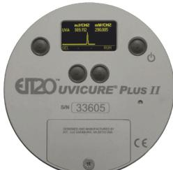
UviCure Plus II是由 EIT2.0 LLC 开发的一款单频段紫外线辐射计，专为宽带紫外线固化系统设计。它广泛应用于工业领域，用于监测、记录、维护和故障排除紫外线固化条件。
