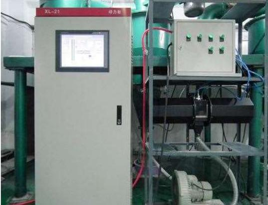
El sistema de monitoreo del tamaño de partículas en línea para la producción de polvo es una instalación necesaria que mejora la calidad del producto, reduce el consumo de energía, aumenta la producción y mejora el nivel automático de producción.
