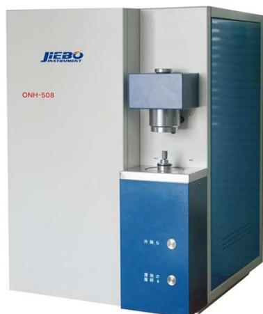
El analizador de oxígeno, nitrógeno e hidrógeno ONH-508 se basa en un sensor piroeléctrico y tecnología de detector de conductividad térmica, utilizando el método de fusión de gas inerte para analizar acero, tierras raras, aleaciones, cobre, zirconio, titanio, cerámica, polvo. Análisis simultáneo de Contenido de oxígeno, nitrógeno e hidrógeno en materiales y otros materiales inorgánicos.
