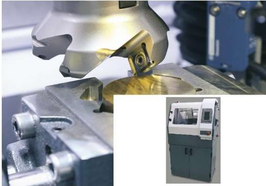
Fresadora automática de superficies finas para la preparación de muestras de metales no ferrosos para OES y Análisis XRF.
