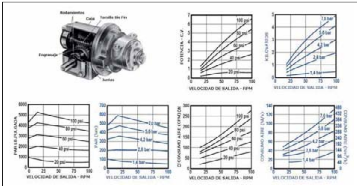
Fig. 5.18 Motor neumático de aletas con engranajes reductores. Fuente: CAST
