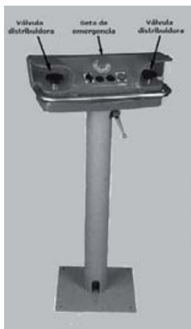
Fig. 2.64 Función Y (AND) con dos válvulas 3/2 en serie
