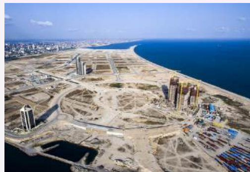
Eko Atlantic City. Un projet visionnaire situé à Lagos, au Nigeria, adjacent à Victoria Island et Lekki. Une fois achevé, il s'étendra sur un total de 10 millions de mètres carrés de terres gagnées sur la mer, dont 6 520 000 m 2 sont déjà aménagés à ce jour. © ownhome.ng
