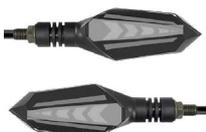
Luces direccionales con foco led, con secuencia de color ámbar, luz diurna, cara opuesta con luz 12 voltios, 3 pines
