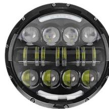
Faro circular, luz led alta y baja blanca con lupa y luz diurna tipo neon blanca y ambar, med:7", 8v-24v, H4
