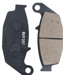
Balatas semi-metálicas de disco trasera, ref. F15020207
