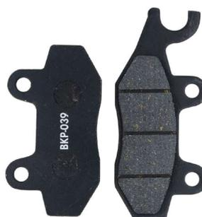
Balatas semi-metálicas de disco delantera, ref. F14020039
