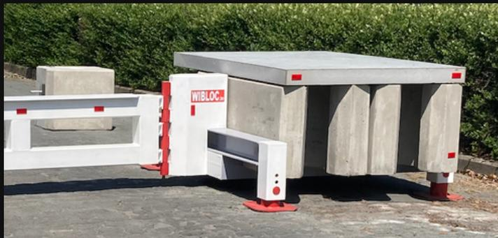
Pour un portail suspendu, tout le poids du portail est supporté par une structure porteuse robuste avec contrepoids (appelée « chaise »). Ainsi, le portail est complètement dégagé du sol et ne nécessite ni roue d'appui ni roue de guidage pour l'ouvrir ou le fermer. Cette conception garantit un fonctionnement fluide et nécessitant peu d'entretien – même sur des surfaces inégales ou non revêtues.
