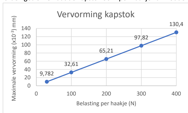
Figuur 29 – Grafiek van vervorming kapstok
