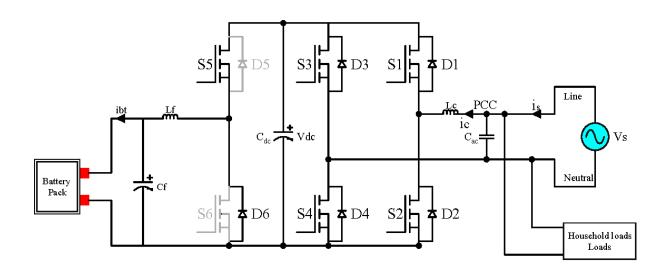
**Grid:** 220 V +/- 10%AC, 50 Hz (+/- 0.5 Hz)
