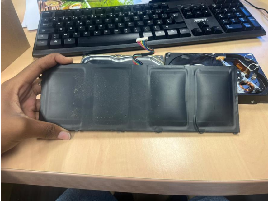
La batterie d'un pc défectueux
