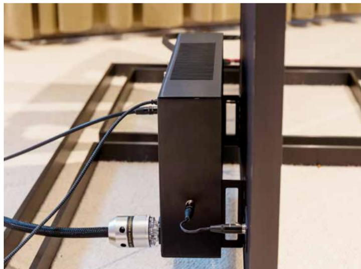
Die Aktivelektronik steckt exzellent gekühlt in einem schwarzen Gehäuse, das direkt am Fuß der LaGrande montiert wird. Die drei Wege werden über kurze Kabel bedient (oben links), die keinen Kontakt zu den Rahmen der Flächenstrahler haben. Unten links ist das kurze Stromkabel zum Betrieb der frontseitigen Betriebslampe zu sehen.
