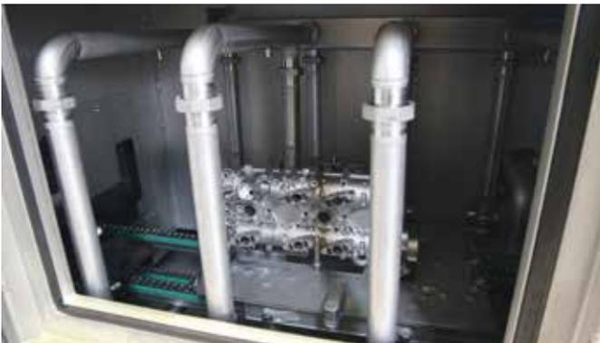
**Nettoyage rapide et économique de couvre-culasses après usinage**
