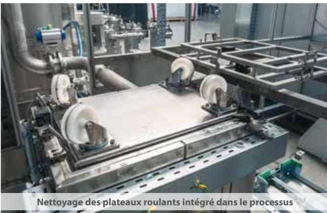
Nettoyage des plateaux roulants intégré dans le processus
