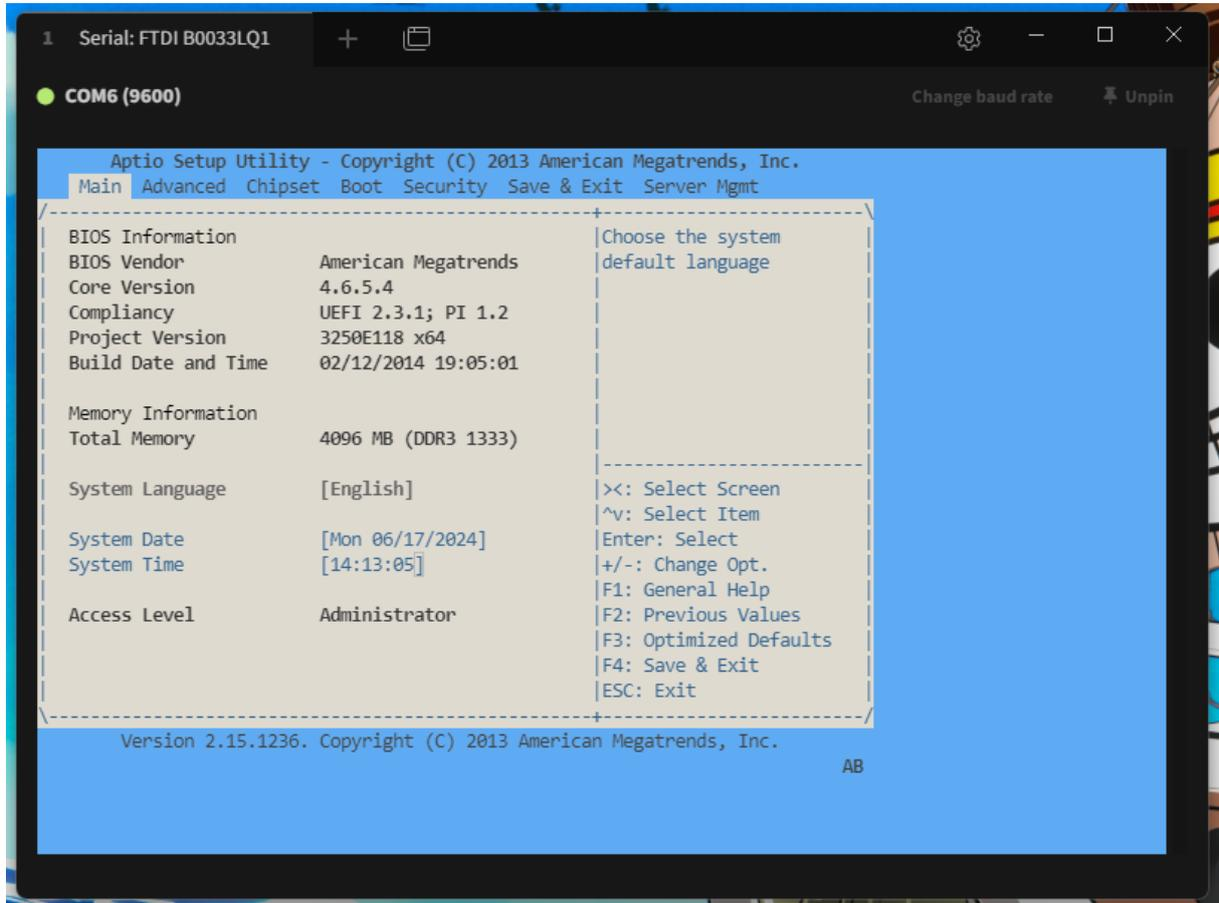
Pour ce faire on ira dans : **Advanced -> LAN ByPass Configuration-> LAN3 & LAN4, LAN5 & LAN6 ByPass** et on les mettra en **NO BYPASS**
