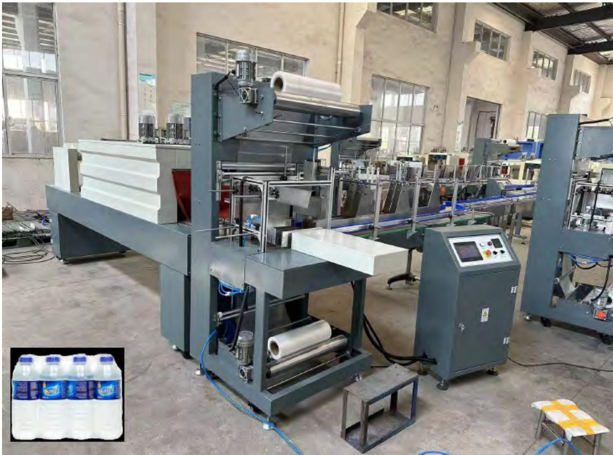
Fig 10: Machine à emballer sous film rétractable 3x4 bouteilles
