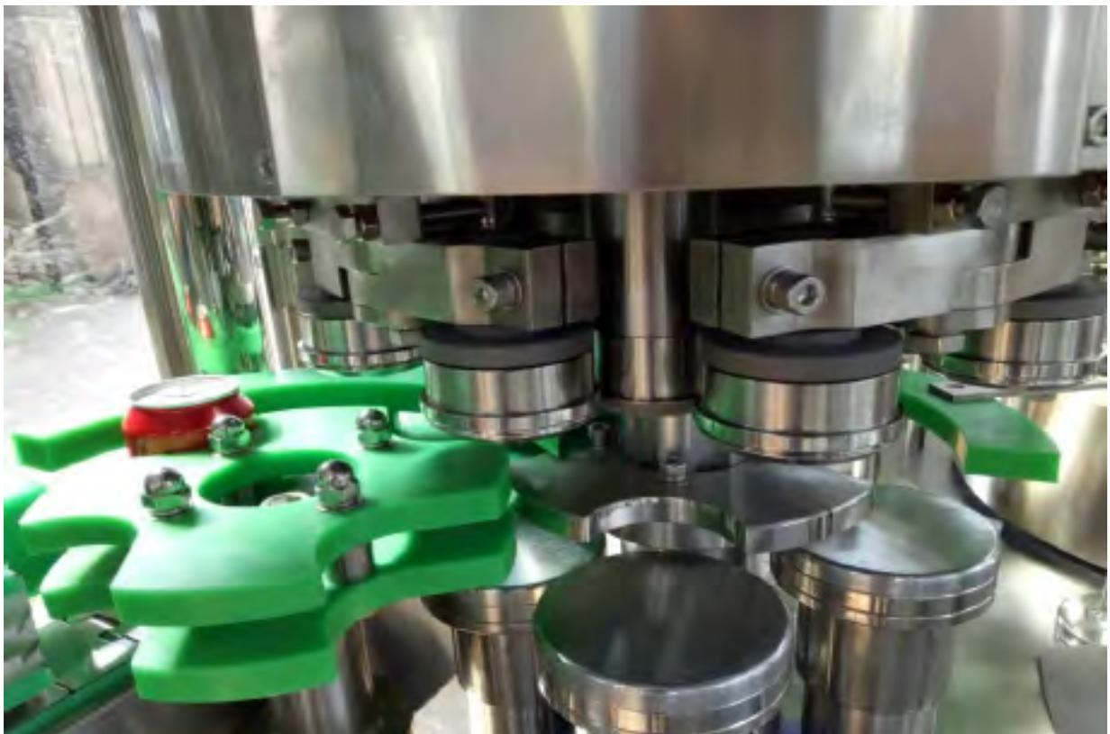
Fig 17: Machine de remplissage de canettes à l'intérieur : en-tête
