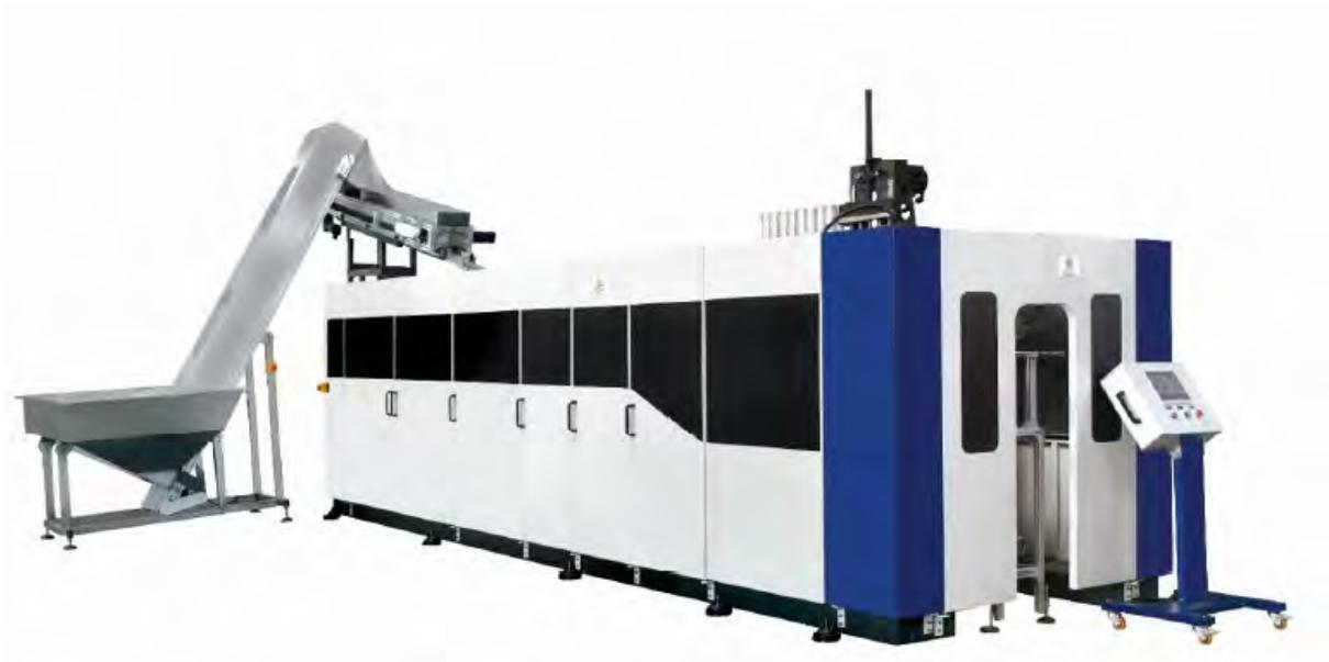
Fig 19: À gauche : élévateur de préformes ; au centre : machine de soufflage de bouteilles
