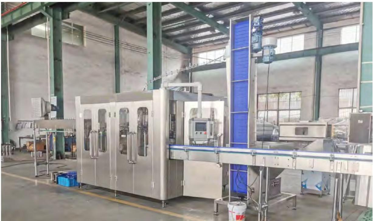
Fig 2: à gauche : machine de remplissage et de bouchage ; au milieu : élévateur de bouchons ; à droite : bande transporteuse
