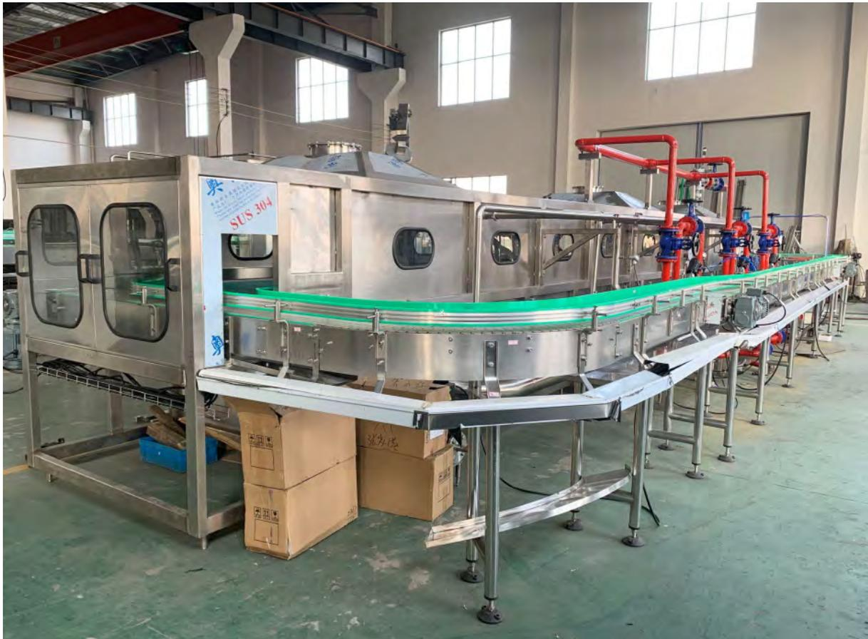
Fig 23: Tunnel de pasteurisation
