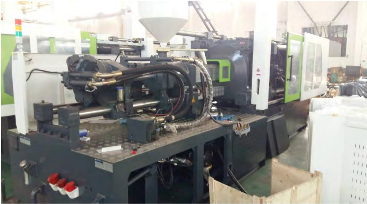
Fig 22: Machine de moulage par injection (2)
