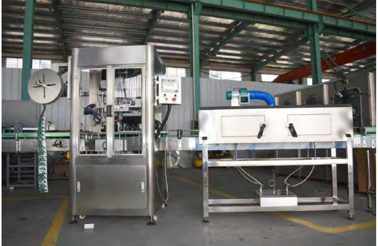
Fig 9: Étiqueteuse et sécheuse
