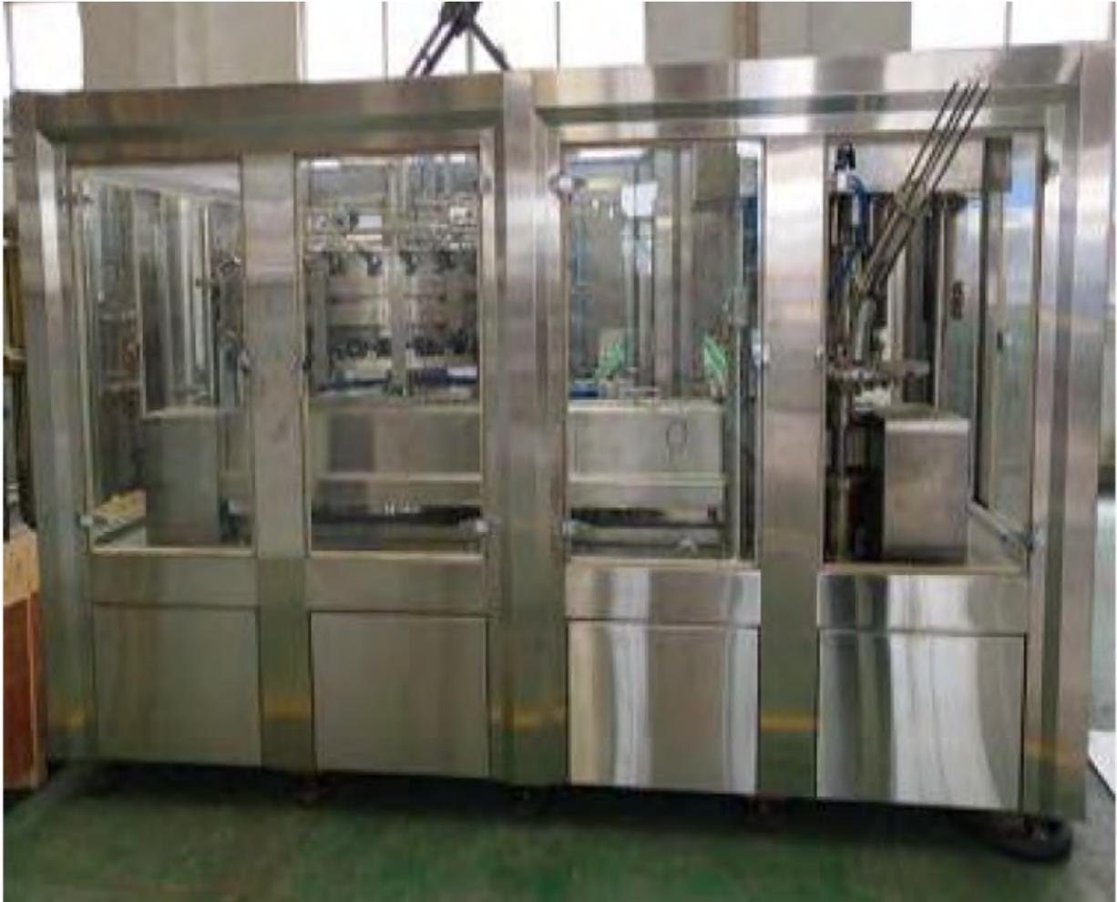
Fig 16: Machine de remplissage de canettes
