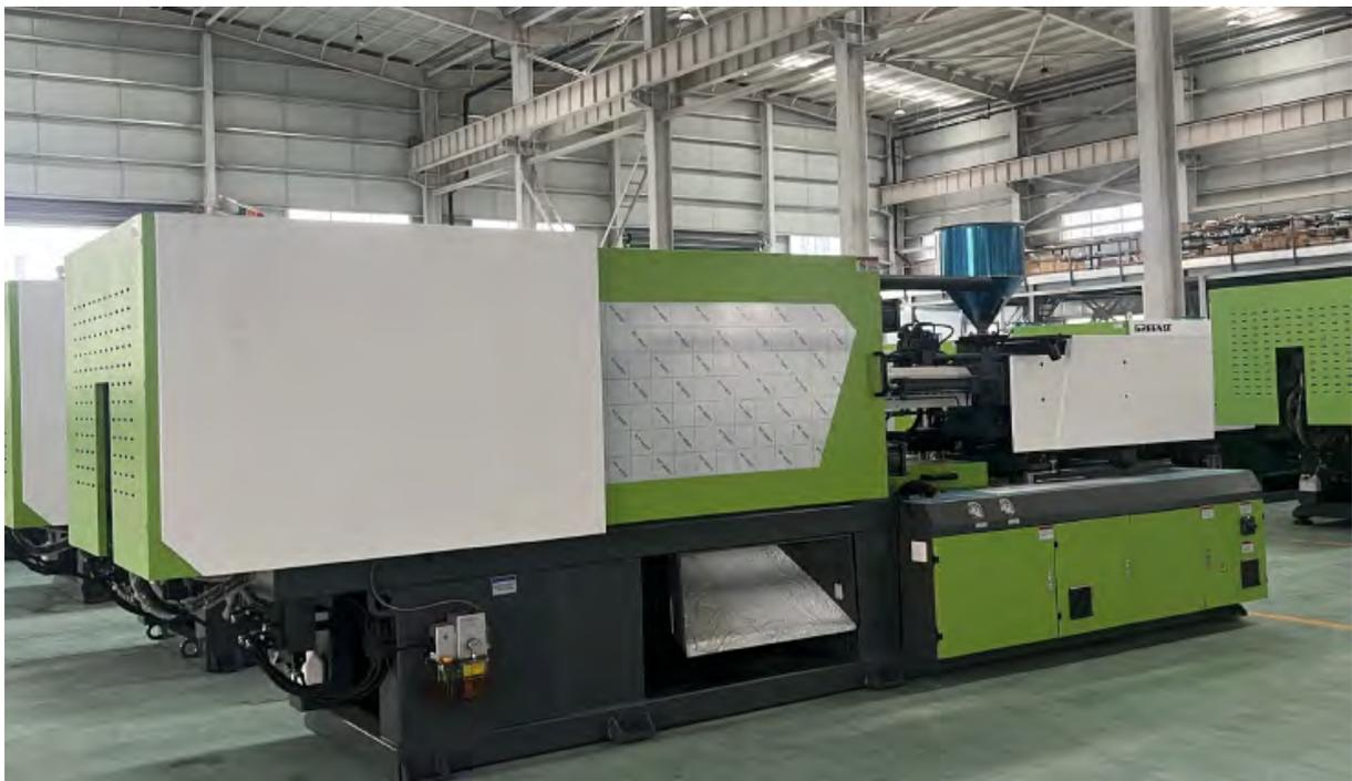
Fig 21: Machine de moulage par injection (1)
