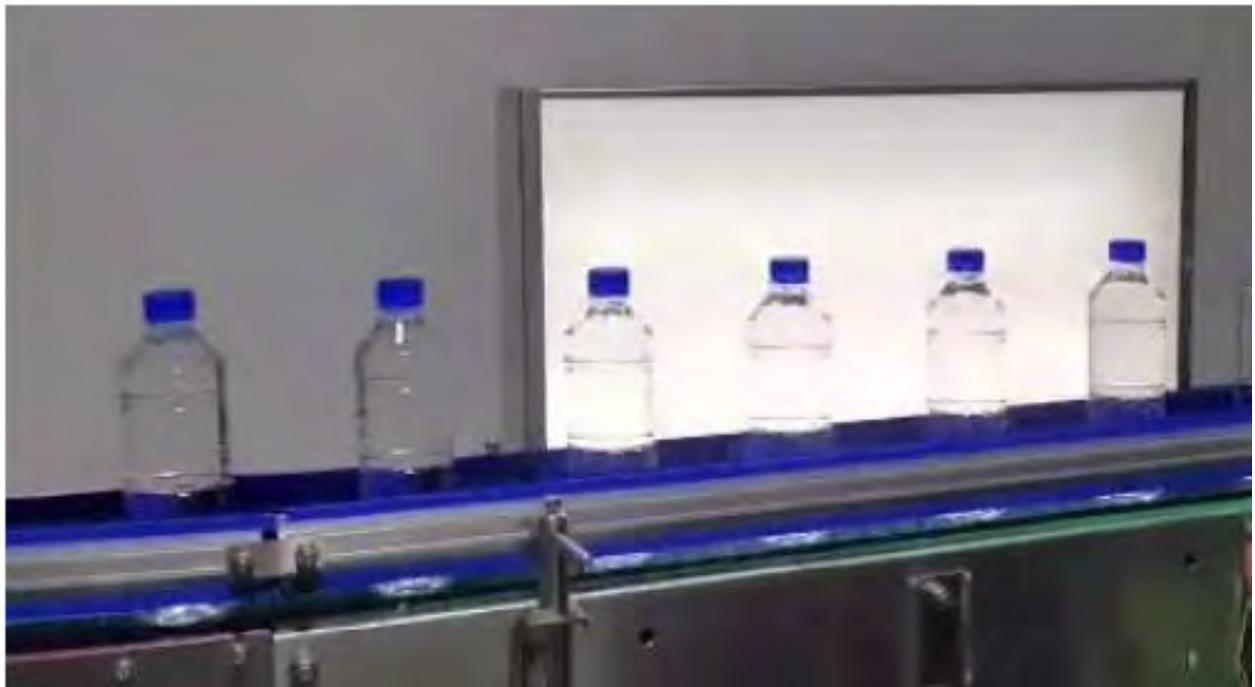
Fig 7: Vérificateur de lumière de type B
