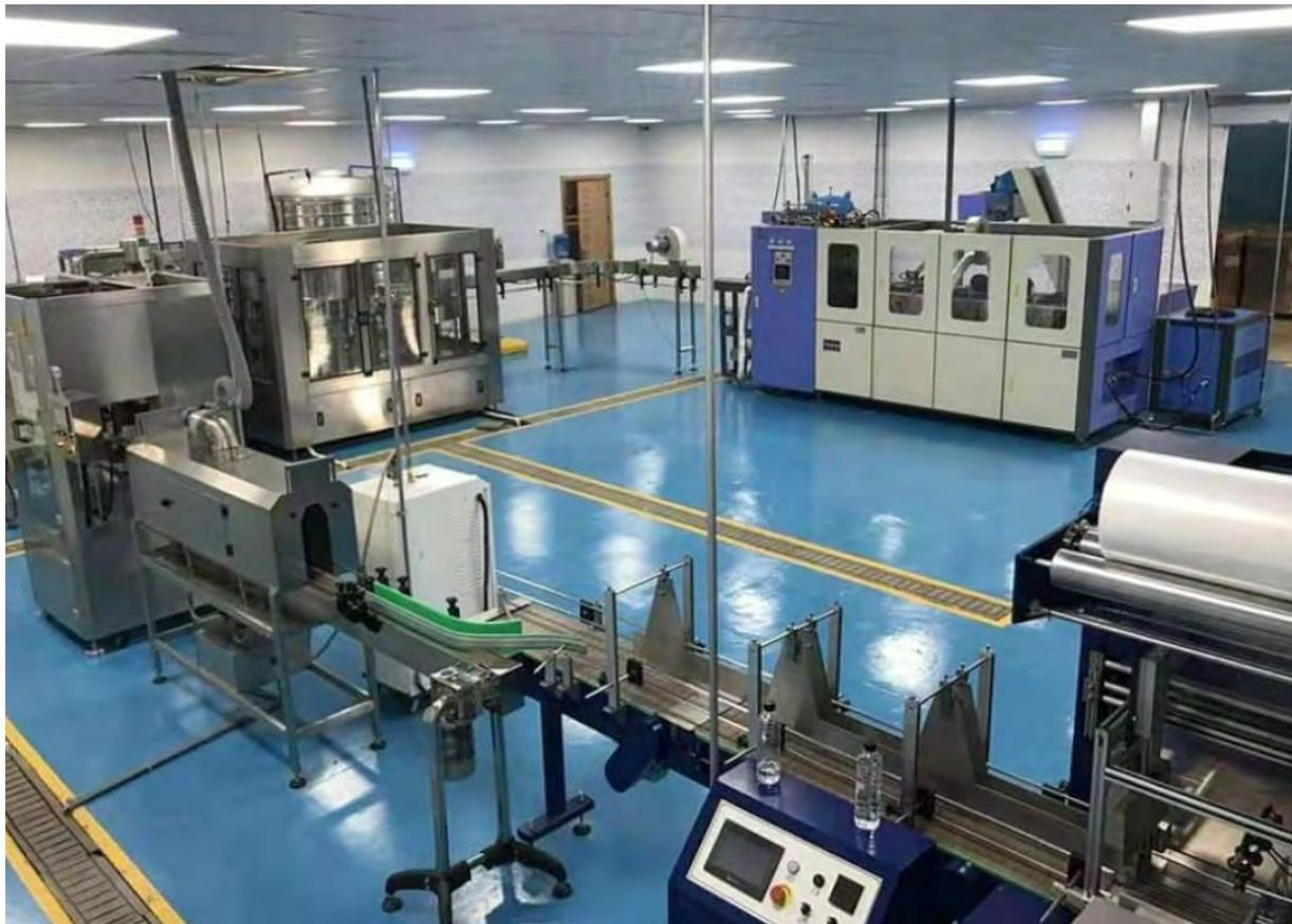
Fig 11: En haut à droite, souffleuse de bouteilles ; en haut à gauche, remplisseuse, capsuleuse, en dessous, tunnel de séchage vers étiqueteuse vers vérificateur lumineux vers fardeleuse (en bas à droite, partiellement visible)
