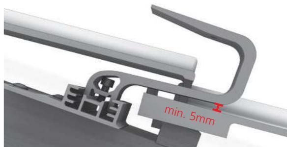
Le crochet doit être monté de manière à obtenir au moins 5 mm entre le bras du crochet et la tuile.
