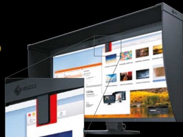
El sensor se desliza sobre el monitor solo durante la calibración.
