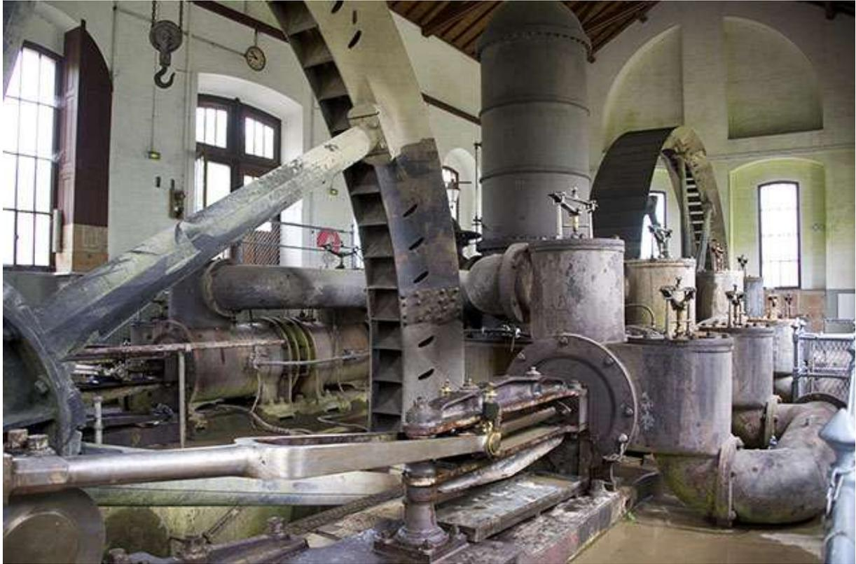
Deux roues en fonte de 10 mètres de diamètre, d'une largeur de 1,80m fonctionnent sous une chute d'eau de 2m actionnant quatre pompes. Cet ingénieur a également construit la turbine électrique de l'usine du chocolatier Menier à Noisiel (aujourd'hui siège social du groupe Nestlé). En 1864, il testait un chemin de fer à propulsion hydraulique, glissant sur coussin d'eau. Son train sera présenté lors de l'exposition universelle de 1889.
