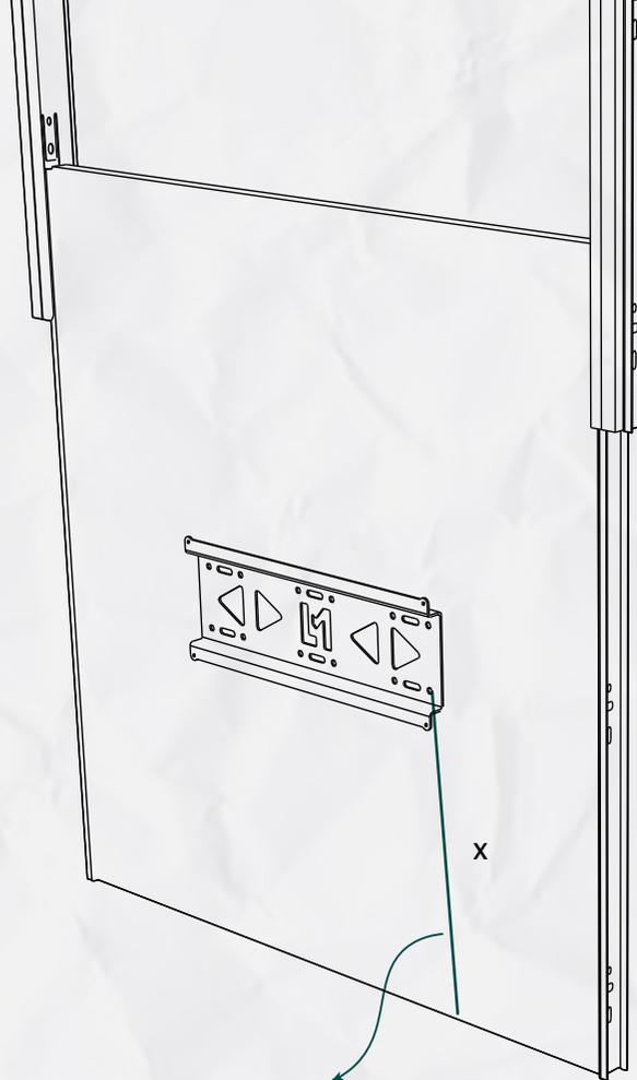
1. - Colocar el soporte en el sistema elevador a la altura que corresponda para que la Tv quede justo al borde superior del elevador.
