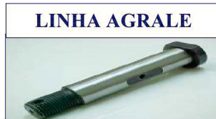
PINO DA MOLA DIANT. P/ TRAS. E TRAS. AGRALE D16000 / D18000. 19 x 110 mm ROSCA 5/8
