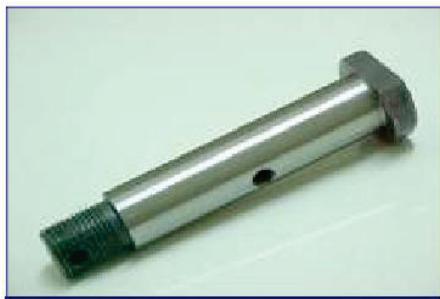
PINO DA MOLA DIANTEIRA F 350 / F 600 (42 Á 71) LONGO 19 x 115 mm
