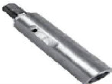
PINO DO SUPORTE DA MOLA TRAS. (SOLDADO NO SUPORTE) 608 D Ø30 x 138 mm S/TEMPERA 722.01 COD. ORIGINAL: 310.320.0275 R$
