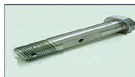
PINO DA MOLA DIANT. CORPO 57mm USA/ CAMINHÃO BRASIL (CURTO) 17,46 x 100 mm ROSCA 5/8 UNF C/ TEMPERA CV8390CE RS S/ TEMPERA CV8390CO RS COD. ORIGINAL: 3 657 393
