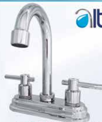
mod: Aseret Cve: AL505 Mezcladora económica p/lavabo, cubierta en ABS, cuerpo y vástagos metálicos, Maneral cilíndrico, cuello tipo Bar, \frac{1}{4} de vuelta, acabado en Cromo .
