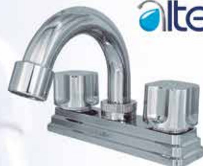
mod: Kiara Cve: AL503 Mezcladora económica p/lavabo, cubierta en ABS, cuerpo y vástagos metálicos, Maneral tipo Queen, cuello tipo mini Bar, compresión (vuelta completa), acabado en Cromo .
