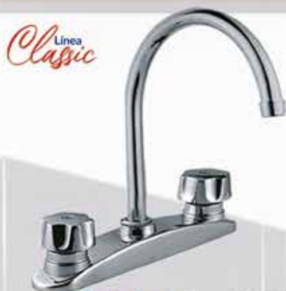
mod: Tundra Cve: F8001 Mezcladora p/fregadero metálica con maneral tipo Queen, con cuello de Bastón, vuelta completa, acabado Cromo .
