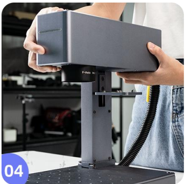
04 4.将光路装置放置于升降轴的直角板，对准后四个螺丝孔
