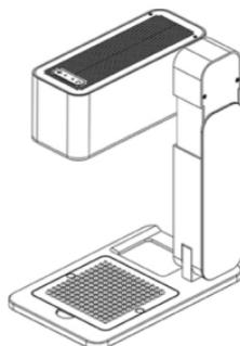
状態③：物置き板を取り付け、突起面を上方向にする場合、小さいものの切断に適用します。
