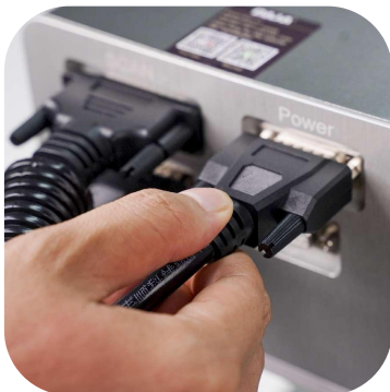
5.插入激光器后方连接线
