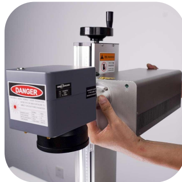
3.将激光器放置立柱托架上
