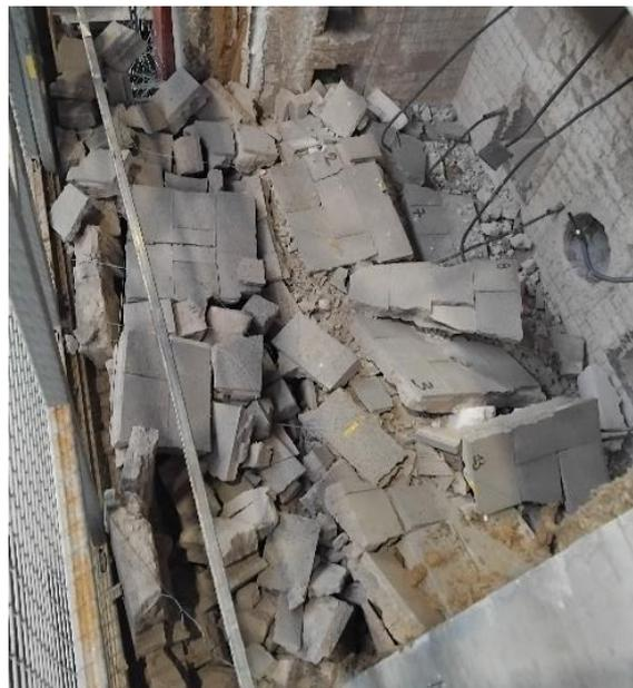
Vue d'ensemble du mur après rupture en phase de refroidissement.
