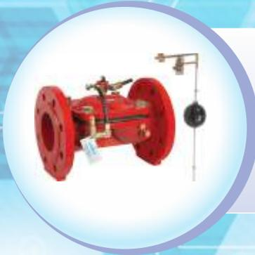
La Válvula de reguladora de nivel es una válvula de control hidráulico diseñada para controlar el nivel de agua en los embalses y tanques en los rangos deseados. La válvula principal se cierra y se sella totalmente sin causar onda cuando el agua alcanza el nivel deseado. La serie 600 de ARMAŞ es un grupo de válvulas hidráulicas de control automático con cerrado de diafragma directo que funcionan en líneas de presión.
