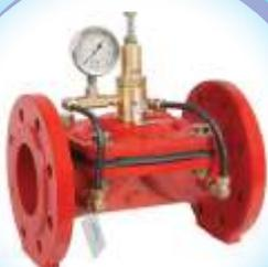
La válvula de control de alivio rápido de la serie "QR" de ARMAŞ es la valvula de control de seguridad diseñada para proteger al sistema mediante la rápida liberación de los picos de presión a la atmosfera causados por cambios bruscos en la velocidad de las bombas de agua, por la frecuente puesta en y fuera de servicio en las líneas de elevación del agua de la red
