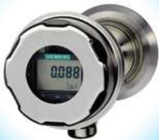
Transmisores de Presión: SITRANS P300, Siemens introduce un transmisor de presión compacto. Construcción de acero inoxidable con diafragma de montaje empotrado soldado para una fácil limpieza y esterilización. Programable con teclas de control locales y pantalla LCD o mediante herramientas de comunicación HART®. Adecuado para temperaturas de proceso sanitarias de hasta 302 ° F, disponible hasta 392 ° F
