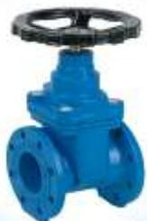
Válvulas de Hierro bridadas Dúctil, en PN16, desde DN50-DN600, aplicación: en Industrias, Arbol Hidráulico de Pozos, Reservorios y Cámaras de Bombeo. Cumplen la Norma ISO 7259, ISO 7005-2. Recubrimientos epóxicos mayor 270 micras.
