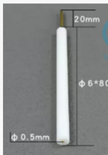
Haste: \phi 6mm área de Au: \phi 0,5mm Modelo: TCH-Au-08
