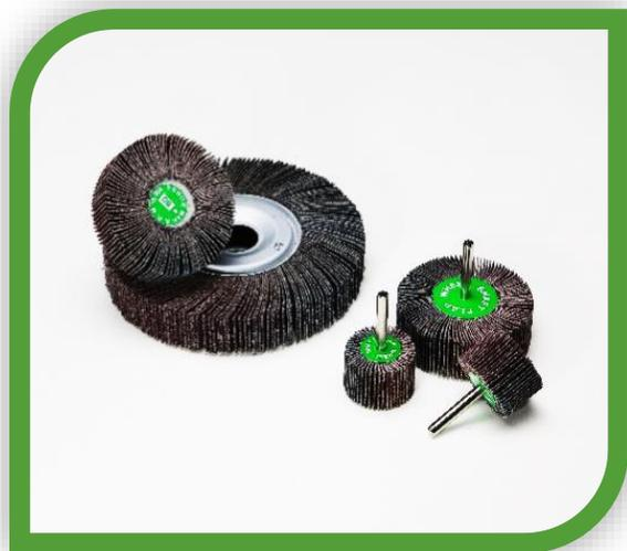
**CARACTERÍSTICAS:** Las ruedas flap son herramientas constituidas con un alto número de lengüetas dispuestas en forma radial, sujetas por dos bridas de acero y soldadas con un potente adhesivo, formando una rueda. Se pueden elaborar en óxido de aluminio y zirconio.
