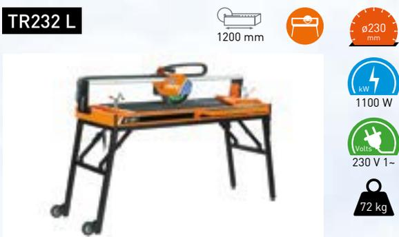
Máquina de bancada compacta y portátil con piernas plegables, con estructura reforzada que garantiza el corte de materiales de hasta 1,2 m de largo.
