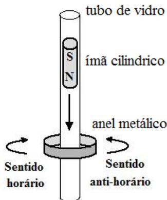
O ímã ao atravessar verticalmente todo o tubo com o polo norte voltado para baixo, provoca uma corrente elétrica induzida no anel. Na figura são indicados os sentidos horário e anti-horário possíveis para a corrente induzida.
