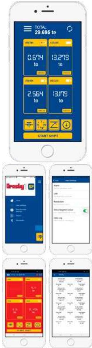
En caso de ser necesario, las celdas de carga Crosby SP Bluetooth habilitadas, se pueden conectar y ser monitoreadas por hasta ocho dispositivos inteligentes con la app instalada. Esto significa que más de un profesional de izaje se puede utilizar durante el izaje con el fin de monitorear el progreso como también identificar potenciales problemas/condiciones desde diferentes puntos de observación.
