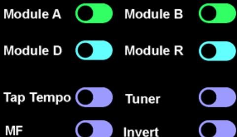
**Importante:** a função double press possui TOGGLE, ou seja, ao pressionar duplamente seguidamente, a função escolhida também alternará de estado, ou seja, por exemplo, se o usuário escolher a função “module A”, ao pressionar duas vezes o footswitch correlato, este ligará o “module A” e ao pressionar duas vezes novamente, desligará o “module A”. Esta funcionalidade expande significativamente o processador KMP.
