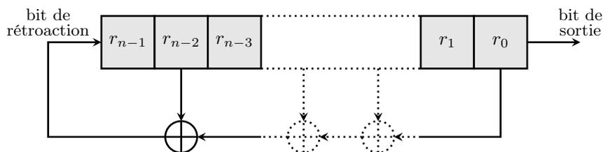
À chaque instant  $t$ , le registre est décalé d'un cran vers la droite en "poussant" chaque bit dans les branches du circuit. Le bit en sortie est alors le bit  $b_t$  de la suite et le bit de rétroaction (calculé en parcourant le circuit logique) est inséré dans la case la plus à gauche du registre laissée libre après le décalage.
