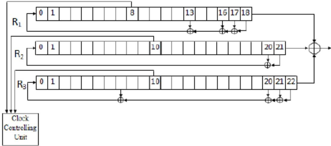
Le chiffrement A5/1 (utilisé dans la norme GSM) combine la sortie de 3 LFSR notés  $\mathcal{L}_1$ ,  $\mathcal{L}_2$  et  $\mathcal{L}_3$  dont les polynômes de rétroaction sont respectivement :
