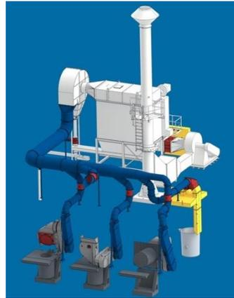
Die Rohrleitung wird entsprechend der erforderlichen Luftmenge ausgelegt und konstruiert. Ihre Anordnung wird der Struktur des vorhandenen Gebäudes angepasst. Die Rohrleitungsführung ist lufttechnisch so optimiert, dass ein geringer Druckverlust und wenige Turbulenzen entstehen. Die Rohrleitungen sind aus geschweißtem 3 mm Blech und sowohl von außen, als auch von innen lackiert.
