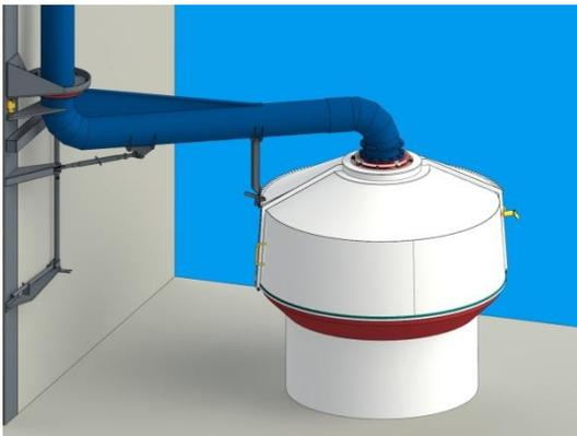
Die Haube deckt den Bereich, in dem sich die Läufer bewegen, vollständig ab. Sie dient der Erfassung der beim Zerkleinerungsvorgang entstehenden Stäube. Zum Öffnen der Haube, z.B. beim Befüllen des Kollergangs, werden die Mantelbleche der Haube gegeneinander verschoben. Um einen noch besseren Zugang zu erhalten, z.B. für Wartungsarbeiten, kann die Haube komplett geöffnet und seitlich weggeschwenkt werden.
