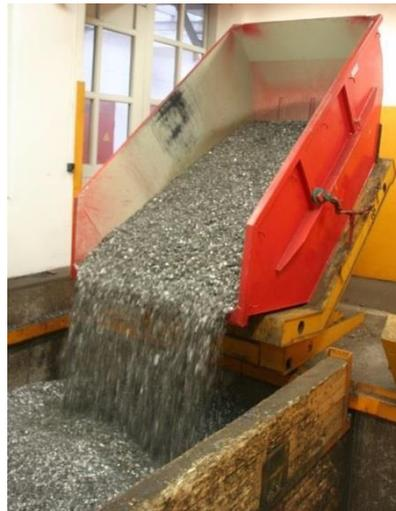
In die hydraulisch schwenkbare Kippvorrichtung werden Mulden eingesetzt. Das Entleeren erfolgt sicher und in der gewünschten Geschwindigkeit und Menge.
