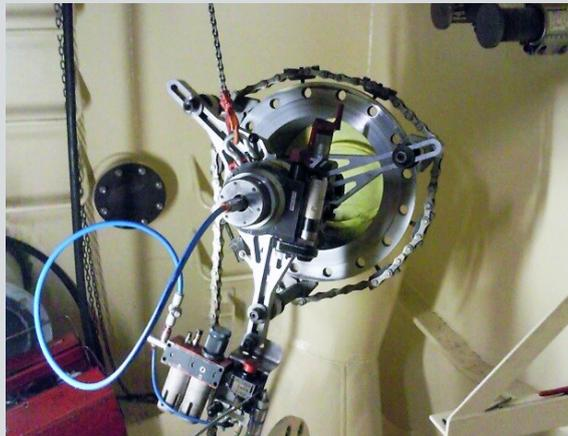
**Descripción:** Designación de los trabajos: Retoque de los asientos de junta y de las dos gargantas de las dos bridas de ACERO DN250 ( $\varnothing$  interior 260 mm,  $\varnothing$  exterior 405 mm), una brida de acero DN300 ( $\varnothing$  interior 310 mm,  $\varnothing$  exterior 460 mm) y tres bridas de acero DN350 ( $\varnothing$  interior 350 mm,  $\varnothing$  exterior 520 mm).
