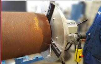
Refrentado y mecanizado de bridas y válvulas
