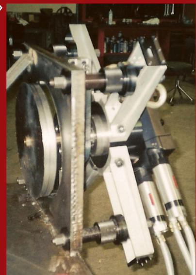
Trepanado de una chapa Retoque brida de cara sobreelevada de 50mm de espesor
