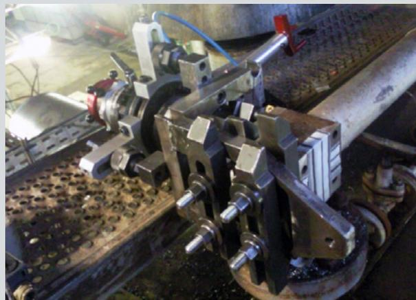
**Descripción:** Designación de los trabajos: Repaso de 3 asientos de estanqueidad en un cabezal de sensor de nivel instalado en una caldera.
