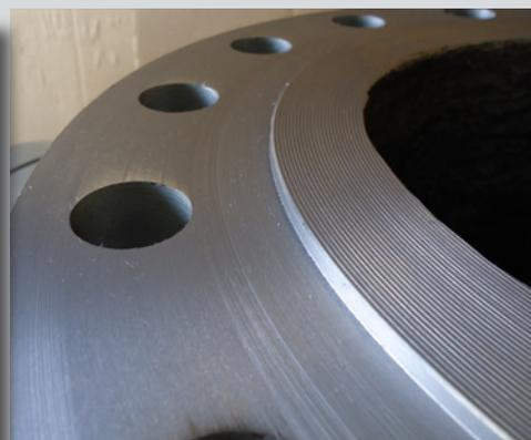
Refrentado de una brida de válvula 10" estado de la superficie en el asiento de junta "stock-finish".
