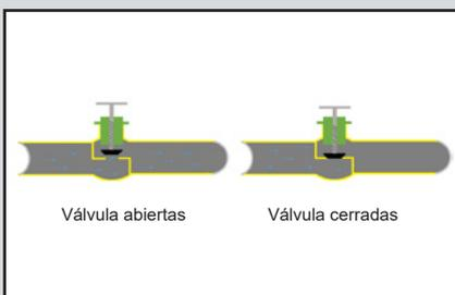
Este tipo de válvula es adecuada para el control del flujo de fluidos. El grifo de válvula se acciona mediante un volante. Cuando la válvula se presiona contra el asiento de la válvula, la válvula está cerrada.
