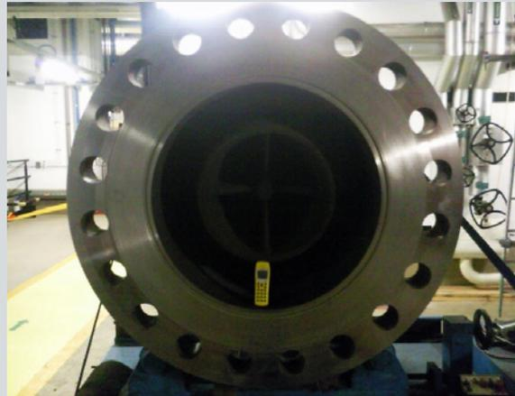
**Descripción:** Designación de los trabajos: Retoque del asiento de la junta + del asiento del perno en una brida de válvula y en una brida de tubería, a raíz de un problema de deformación debido a un apriete excesivo. Mecanizado corte en paralelo  $\varnothing$  exterior 1150 mm (45.275").
