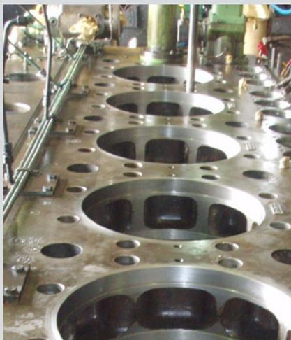
Mecanizado de los 6 cilindros + instalación de las inserciones en 10 días
