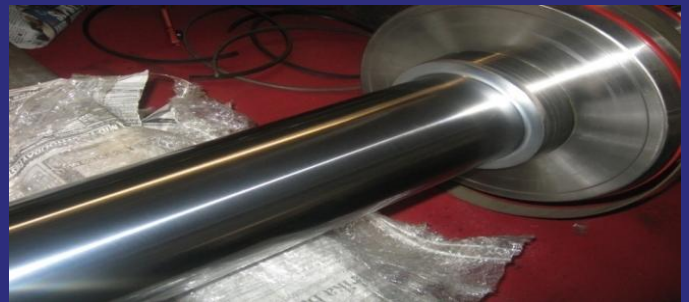
Setelah Process Hard Chrome "Mengkilat, Halus, Kekerasan permukaan s/d 60 HRC"
