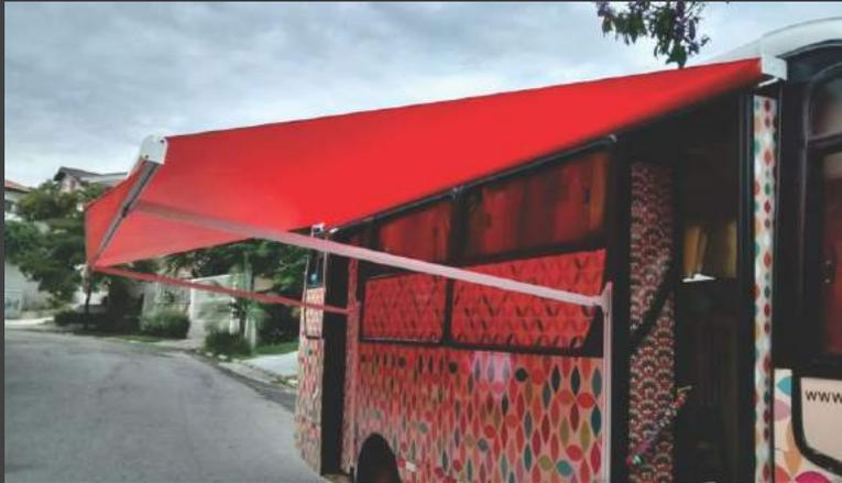
O toldo retrátil tensor é produzido 100% em alumínio com pintura eletrostática, ideal para cidades litorâneas. Projetado à partir de braços tensores com molas internas que proporcionam uma ótima tensão do tecido.
