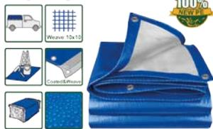
Lona de polietileno Tamaño terminado: 2m\*3m (PIES: 6.5x9.8) Material: 100% PE nuevo Peso: 110g/m<sup>2</sup> Tejido: malla 10\*10 Grosor: 0.15mm Ojales de aluminio cada 100cm para fácil sujeción Laminado y recubrimiento en ambos lados con 100% PE nuevo Ideal para impermeable; a prueba de nieve, a prueba de polvo, protector UV Empaque en bolsa de polietileno con papel de color
