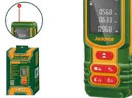
Rango de medición: 0.05-60m Precisión de medición: ±2.0mm Tipo de láser: 635nm, <1mW, Clase 2 Función: medición única/medición continua/medición indirecta/medición de área/medición de volumen/medición del teorema de Pitágoras simple/doble Pitágoras más/doble Pitágoras menos/doble medición de área Batería: 2\*1.5 AAA Temp. de operación: 0°C ~ +50°C Empacado en caja de color
