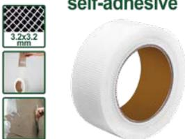
Cinta de malla autoadhesiva de fibra de vidrio Material: fibra de vidrio Longitud: 45m Ancho: 50mm Malla: 3.2x3.2mm Densidad: 65g/m<sup>2</sup> Color: blanco Excelente viscosidad y adhesión superficial Se utiliza para juntas de placas de yeso y paredes, puede mejorar la adhesión de los revestimientos Empacado por retracción
