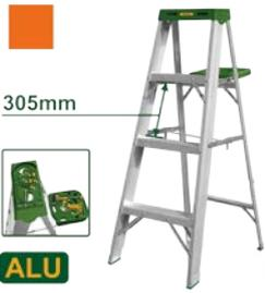
Material: aluminio Escalera lateral con bandeja para herramientas Último peldaño: mesa de herramientas de plástico Peldaños: 3+1 peldaños Tamaño abierto: 465x800x1150mm Tamaño cerrado: 470x135x1260mm Altura del peldaño: 305mm Peso aprox.: 3.8kg Carga máx.: 150kg(330lbs) Empacado en film retráctil
