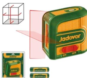
Nivel láser rojo Rango de trabajo: 0~15m Precisión de nivelación: ±2mm@5m Precisión de línea: ±2mm@5m Tiempo de nivelación: ≤3s Ángulo de autonivelación: ≤4° Tipo de láser: 635±5nm Clase de láser II <1mW Con función de bloqueo de cruce láser Con función de línea horizontal y vertical Temperatura de funcionamiento: 0~+40°C Temperatura de almacenamiento: -10~+50°C Pilas LR6 AA(1.5V)\*2 Empacado en doble blister
