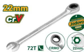
Llave de carraca de 22 mm Longitud: 287 mm Material del cuerpo: Cr-V Material de la cabeza: CrMo Carraca forjada, tratamiento térmico Cromado, acabado mate Empaquetado en tarjeta de papel
