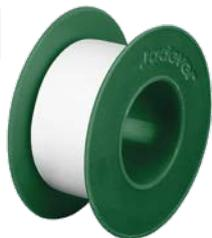
Cinta de sellado de roscas de PTFE Material: PTFE (teflón) Longitud x Ancho: 3/4"(19mm)x-7m Espesor: 0.075mm Elongación: 12% Densidad: 0.30 g/cm³ Resistencia a la tracción: 0.90 kg/mm² Color: blanco Para sellar conexiones y prevenir fugas, tuberías de metal galvanizado, plástico, acero inoxidable, bronce, cobre y aluminio Empaquetado por etiqueta
