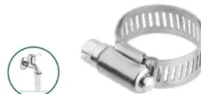
Rango adecuado: 10-16mm Ancho de banda: 8mm 50 piezas/bolsa de plástico El tornillo de cabeza hexagonal ranurada Banda y carcasa en acero inoxidable, tornillo en acero al carbono con zincado Empacado por colgador de papel
