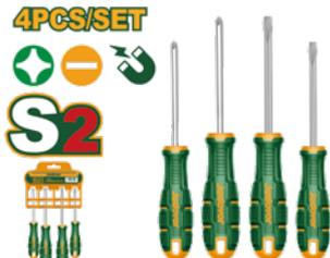
Juego de destornilladores de 4 piezas Material de la hoja: S2 Tipo de vástago: redondo 1 pieza SL5.5\*5\*100mm 1 pieza PH1\*5\*100mm 1 pieza SL6.5\*6\*150mm 1 pieza PH2\*6\*150mm Material del mango: ergonómico bicolor Con fuerte imán Empacado en colgador de plástico
