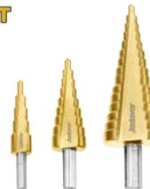
Juego de brocas escalonadas de 3 piezas 1 pieza 4-12mm 2mm/paso Diámetro del vástago 6mm 1 pieza 4-20mm 2mm/paso Diámetro del vástago 8mm 1 pieza 4-32mm 2mm/paso Diámetro del vástago 10mm Material HSS Se aplica a placas de acero con grosor≤3mm Empacado en doble blister
