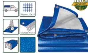
Lona de polietileno Tamaño terminado: 3m\*4m (PIES: 9.8x13.1) Material: 100% nuevo PE Peso: 110 g/m<sup>2</sup> Tejido: malla 10\*10 Espesor: 0.15mm Ojales de aluminio cada 100cm para fácil amarre Ambos lados laminados y recubiertos con 100% nuevo PE Ideal para impermeable; a prueba de nieve, a prueba de polvo, protector UV Empaque en bolsa de polietileno con papel de color
