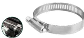
Rango adecuado: 67-83mm (2 2/3"-3 9/32") Ancho de banda: 12.7mm (1/2") 10 piezas/bolsa de plástico El tornillo de cabeza hexagonal ranurada Banda y carcasa en acero inoxidable, tornillo en acero al carbono con recubrimiento de zinc Empacado con colgador de papel
