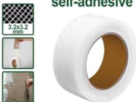
Cinta de malla autoadhesiva de fibra de vidrio Material: fibra de vidrio Longitud: 90m Ancho: 50mm Malla: 3.2x3.2mm Densidad: 65g/m<sup>2</sup> Color: blanco Excelente viscosidad y adhesión superficial Usada para juntas de placas de yeso y paredes, puede mejorar la adhesión de los revestimientos Empacada por retracción
