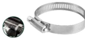
Rango adecuado: 19-44mm (3/4"-1 3/4") Ancho de banda: 12.7mm (1/2") 20 piezas/bolsa de plástico El tornillo de cabeza hexagonal ranurada Banda y carcasa en acero inoxidable, tornillo en acero al carbono con recubrimiento de zinc Empacado con colgador de papel
