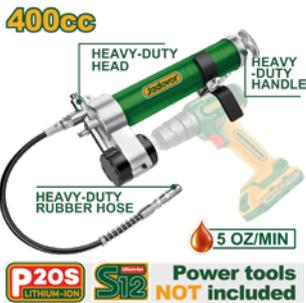
Acople de pistola de engrase Capacidad: 400cc/14Oz Forma de carga: cartucho de 14Oz/400cc A granel Presión de trabajo: 4000psi Presión de ruptura: 8000psi Material: aluminio 1/4" DR 3 formas de carga: cartucho de 14Oz/a granel/dispensador Incluye: 1 pieza de manguera de grasa de nylon de alta presión de 18" 1 pieza de soporte Adecuado para taladro inalámbrico de iones de litio, destornillador de impacto, taladro de impacto y taladro eléctrico Empacado en caja de color
