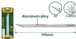
Cuchillo de precisión para hobby Cuerpo de aleación de aluminio 5 piezas de cuchillas SK5 Tamaño de la cuchilla: 8mm\*37.5mm Longitud: 145mm Empacado en tarjeta deslizante
