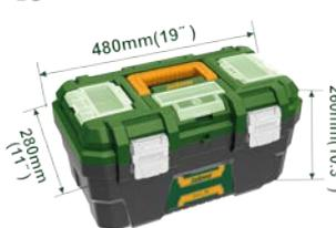
Caja de herramientas de plástico de 19" Tamaño de la caja: 480mm(19")x280mm(11")x-260mm(10.3") Material: plástico PP Hebilla de metal Carga máxima: 18kg Mango de alta resistencia Tapa superior con tres áreas de almacenamiento Tapa superior con función de escala Contiene 1 bandeja de plástico Empacado en caja de cartón
