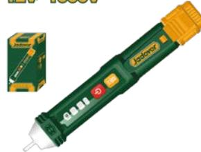
Voltaje de CA: 12V~1000V (Alta sensibilidad) 48V~1000V (Baja sensibilidad) Frecuencia: 50/60Hz Modo de alarma: Alarma de sonido y luz Linterna: LED blanco Apagado automático Con 2 pilas R03 AAA Empacado en caja de color
