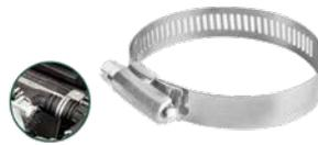
Rango adecuado: 46-70mm (1 13/16"-2 3/4") Ancho de banda: 12.7mm (1/2") 10 piezas/bolsa de plástico El tornillo de cabeza hexagonal ranurada Banda y carcasa en acero inoxidable, tornillo en acero al carbono con recubrimiento de zinc Empacado con colgador de papel
