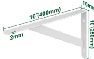
Dimensiones del soporte: 40\*25 CM Espesor: 2mm Capacidad de carga (por par): 60kgf 7 puntos de fijación Color: Blanco Accesorios de montaje no incluidos Empaquetado por etiqueta
