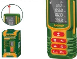
Rango de medición: 0.05-100m Precisión de medición: ±2.0mm Tipo de láser: 635nm, <1mW, Clase 2 Con medición de ángulo Función: medición única/medición continua/medición indirecta/medición de área/medición de volumen/medición de teorema de Pitágoras simple/doble Pitágoras más/doble Pitágoras menos/doble medición de área Batería: 2\*1.5 AA Temp. de operación: 0°C ~ +50°C Empacado en caja de color
