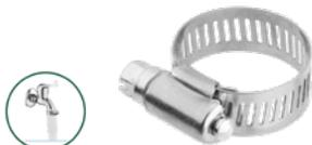
Rango adecuado: 6-16mm Ancho de banda: 8mm 50 piezas/bolsa de plástico Tornillo de cabeza hexagonal ranurada Banda y carcasa en acero inoxidable, tornillo en acero al carbono con recubrimiento de zinc Empacado con colgador de papel
