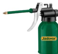
Capacidad: 250 mL; Material: ST14; Grosor: 0.4 mm; Cuerpo de acero completo; Duradero y resistente al óxido; Base ancha para mayor estabilidad; Cuerpo sin costuras no gotea en la parte inferior; Boquilla de plástico desmontable, la boquilla de aceite utiliza cobre puro para distribuir el aceite uniformemente; Gatillo de bomba fácil de usar con el pulgar, compacto y perfecto para trabajos de aceite en espacios reducidos para el hogar, automóvil u otras aplicaciones. Empaque por etiqueta.
