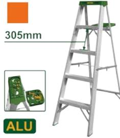
Material: aluminio Lado de la escalera con bandeja para herramientas Último peldaño: mesa de herramientas de plástico Peldaños: 4+1 peldaños Tamaño abierto: 504x1000x1440mm Tamaño cerrado: 513x135x1570mm Altura del peldaño: 305mm Peso aprox.: 4.8kg Carga máx.: 150kg(330lbs) Empacado con film retráctil
