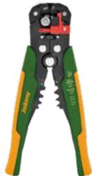
3 en 1 multifunción Desforrar, cortar y engarzar Rango de desforre de cables: 10AWG~24AWG (0.2-6mm²) Función de corte: Cables de cobre y aluminio Función de engarzado: Engarzar los terminales aislados 0.5-6mm² (10-22 AWG); Engarzar los terminales no aislados: 4-6mm² (12-10 AWG); Engarzar los terminales no aislados: 1.5-2.5mm² (16-14 AWG); Engarzar los terminales no aislados: 0.5-1mm² (22-18 AWG); Mango duradero y cómodo Empacado en tarjeta deslizante
