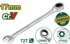
Llave de carraca de 17 mm Longitud: 227 mm Material del cuerpo: Cr-V Material de la cabeza: CrMo Carraca forjada, tratamiento térmico Cromado, acabado mate Empaquetado en tarjeta de papel
