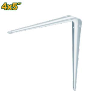
Dimensiones del soporte: 4 pulgadas x 5 pulgadas (10\*12 cm) Espesor: 0.8 mm Capacidad de carga (por par): 15 kgf 6 puntos de fijación Color: Blanco Accesorios de montaje no incluidos Empaquetado por etiqueta
