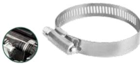
Rango adecuado: 38-57mm (1 1/2"-2 1/4") Ancho de banda: 12.7mm (1/2") 20 piezas/bolsa de plástico El tornillo de cabeza hexagonal ranurada Banda y carcasa en acero inoxidable, tornillo en acero al carbono con recubrimiento de zinc Empacado con colgador de papel
