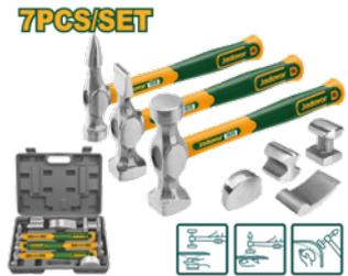
Juego de 7 piezas de martillos para carrocería y guardabarros (mango de nogal genuino) 1 pieza de martillo con extremo de cincel 1 pieza de martillo de pico 1 pieza de martillo de golpeo 1 pieza de dolly de contracción 1 pieza de dolly de doble extremo 1 pieza de dolly curvado 1 pieza de dolly de talón Cabeza de martillo forjada en caliente Tratamiento térmico, acero al carbono 45# Empacado en caja de plástico
