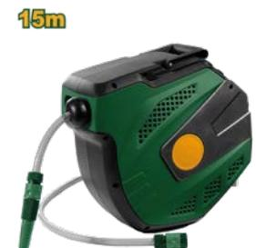
Retracción lenta y parada automática Longitud de la manguera: 15+1.5m Tamaño de la manguera: 1/2" Material de la manguera: PVC Material de la carcasa: plástico PP Presión de trabajo: 150psi Empacado en caja de color
