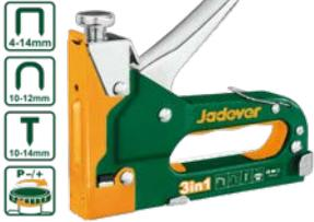
Pistola de grapas 3 en 1 Fuerza de disparo ajustable Grapas: Alambre: 1.2mm, Corona: 11.3mm, Longitud: 4-14mm Grapas en forma de U: Alambre: 1.2mm, Corona: 6.3mm, Longitud: 10-12mm Clavos de cabeza: Alambre: 1.2mm, Longitud: 10-14mm Empacado en tarjeta deslizante
