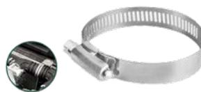
Rango adecuado: 72-95mm (2 13/14"-3 3/4") Ancho de banda: 12.7mm (1/2") 10 piezas/bolsa de plástico El tornillo de cabeza hexagonal ranurada Banda y carcasa en acero inoxidable, tornillo en acero al carbono con recubrimiento de zinc Empacado con colgador de papel
