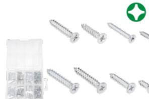
200 Piezas/conjunto Tornillos autorroscantes de cabeza avellanada Material: acero al carbono Tratamiento superficial galvanizado Impulsión del tornillo: phillips Tamaño y cantidad: 51 Piezas - 3x12mm 30 Piezas - 3.5x25mm 40 Piezas - 3.5x12mm 30 Piezas - 3.5x19mm 20 Piezas - 4x19mm 15 Piezas - 4x25mm 14 Piezas - 5x30mm Empacado en caja de plástico
