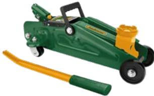
2 toneladas Min. altura: 140 mm Max. altura: 285 mm Recorrido: 145 mm Peso: 6.2 kg Empacado en caja de color
