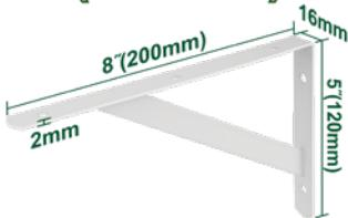
Dimensiones del soporte: 20\*12 CM Espesor: 2 mm Capacidad de carga (por par): 50 kgf 6 puntos de fijación Color: Blanco Accesorios de montaje no incluidos Empaquetado por etiqueta
