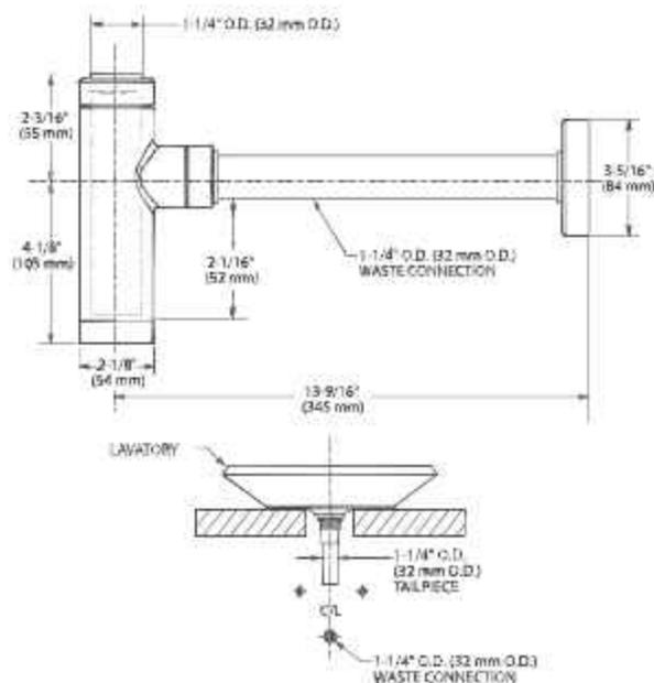
El tubo final debe de estar colocado en la misma línea central que la conexión de salida de residuos.
