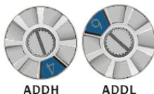
CME-PD01 tiene dos llaves selectoras rotativas para que el usuario seleccione la dirección DE PROFIBUS. El valor configurado mediante dos conmutadores de direcciones, ADDH y ADDL, está en formato HEX. ADDH configura los 4 bits superiores, y ADDL configura los 4 bits inferiores de la dirección de PROFIBUS.
